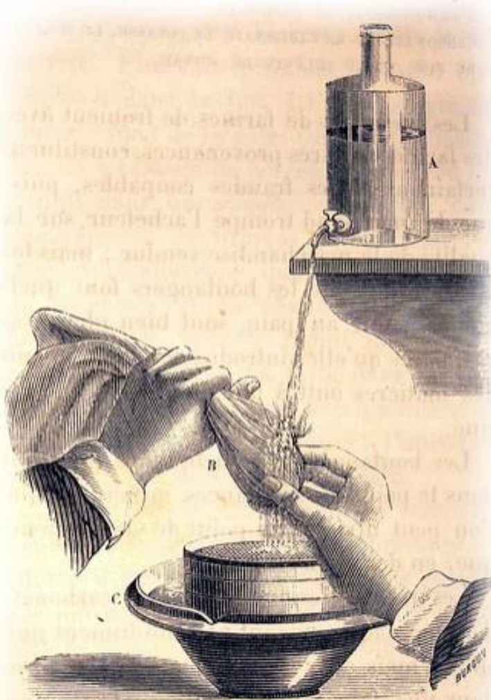
Fig. 46. — Séparation du gluten de la farine des céréales au moyen d'un courant d'eau.
