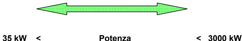
Fig. 1. Il Titolo II si applica agli impianti termici civili aventi potenza termica nominale compresa nell'intervallo in figura
