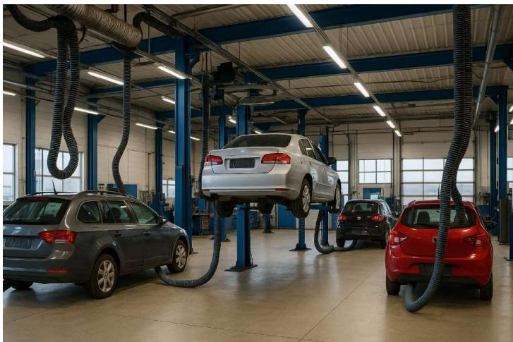
A seconda delle caratteristiche dell'ambiente di lavoro e del tipo di attività, è necessario scegliere e configurare un impianto con l'obiettivo di estrarre dalla fonte (tubo scappamento/marmitta del veicolo) la maggior quantità di inquinanti per essere filtrati e convogliati all'esterno in atmosfera.
