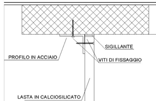
Creazione di condotta a protezione di tubi o canali che attraversano locali, con sostegno in angolari metallici e pendini, quando non sia possibile realizzare condotte compartimentate autonome ed autoportanti.
