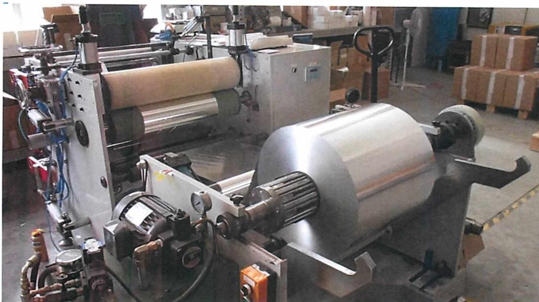
Figura 2 – Vista della parte posteriore della macchina dove avviene il carico dei rotoli
